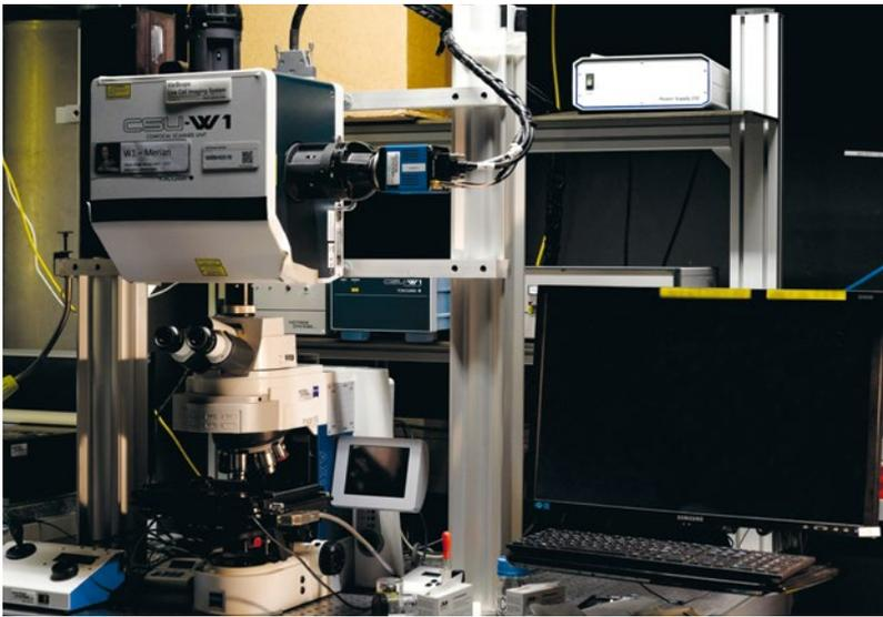
Die im Zeitraffer vom abgebildeten Konfokalmikroskop mit rotierender Scheibe aufgenommenen Bilder visualisieren die Kinetik von fluoreszierenden Proteinen in lebenden Zellen. Die Bewegung einzelner Moleküle in Zellen wird unter Normalbedingungen und bei Krankheit charakterisiert.
