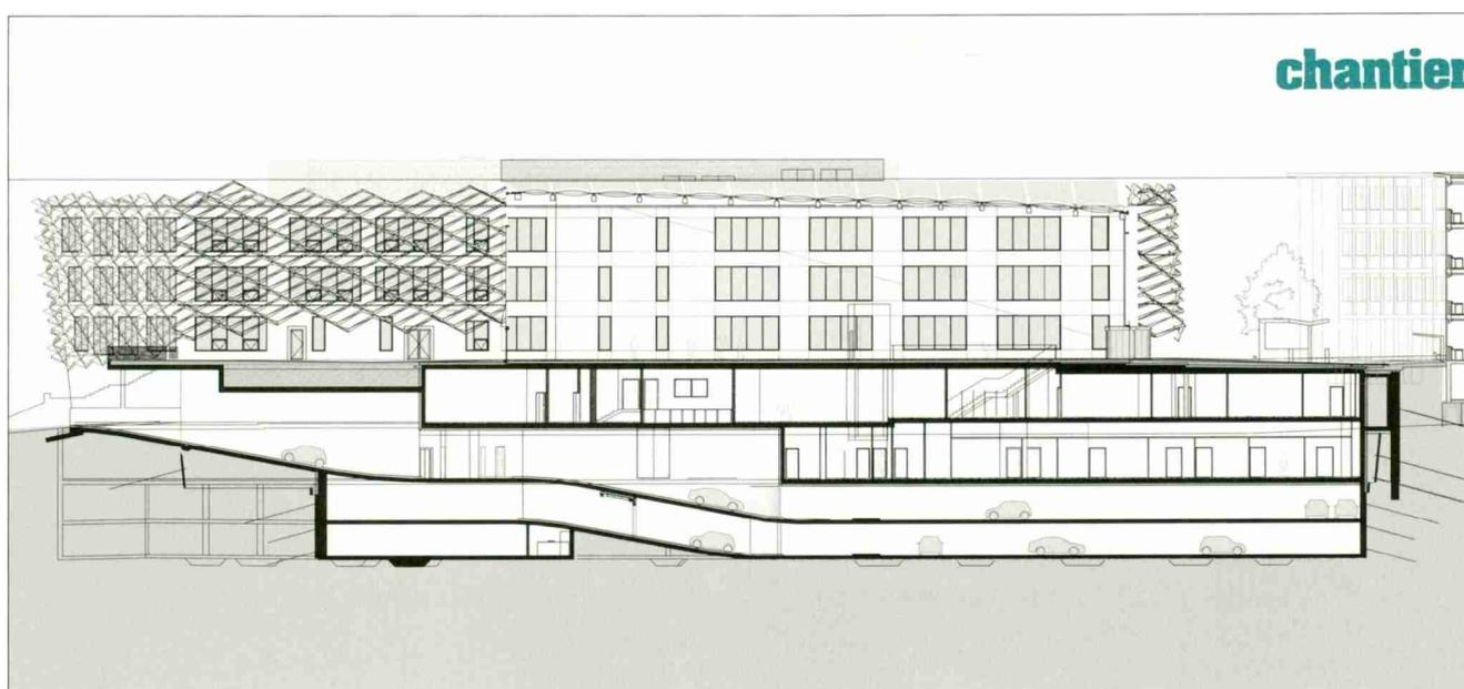
Ci-dessus, la coupe G-G qui met en évidence les quatre niveaux excavés au nord, dont les deux étages de parking, et deux niveaux de locaux, chacun de 4 m de haut. Au sud, l'entrée du parking.
